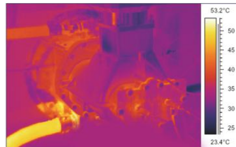
Beperkte toename van de temperatuur van slechts 25 °C in het compressorelement
